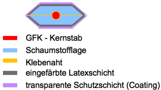
Abb. 10: Lagenweiser Aufbau an einem generischen LARP- Klingenquerschnitt, schematisch
